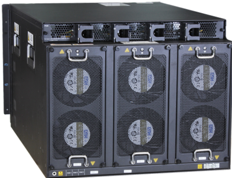
图 3-10 CE12804S 交流&高压直流机框外观（背面）
