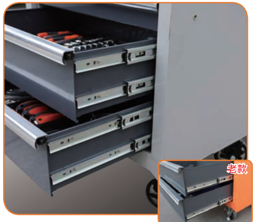
导轨和轨道，由原卡点安装升级为铆接安装，抽屛固定更加牢固、顺滑；6、7、8抽工具车，底层的抽屛升级为双导轨，承重能力提升50%以上；
