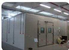
长寿命试验(40°C, 满载, 测试180天)
